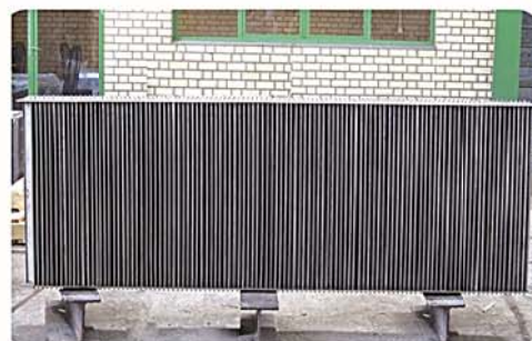
فیلتر گاز ترش مجتمع پارس جنوبی
